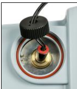
Install the new tungsten filament lamp module.
