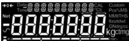
Nach der angemessenen Aufwärmzeit können Sie mit dem Wiegen beginnen. Geben Sie ein zu wiegendes Objekt auf die Waage. Sobald die Waage stabil ist, wird dies mit **↺** angezeigt, dass die Waage stabil ist. Ist dies nicht der Fall, ist **↺** ausgeblendet.
