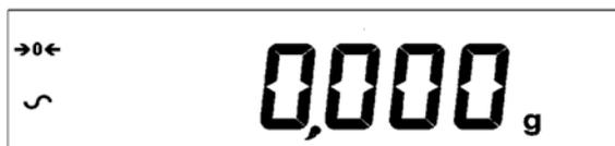
Es wird null als Messwert angezeigt, zusammen mit dem Symbol "→0←" und der zuletzt verwendeten Gewichtseinheit. Ist automatische Kalibrierung basierend auf Zeit aktiviert, wird die Waage 15 Minuten nach Einschalten, oder erneut nach einem gesetzten Zeitintervall, eine Kalibrierung durchführen.
